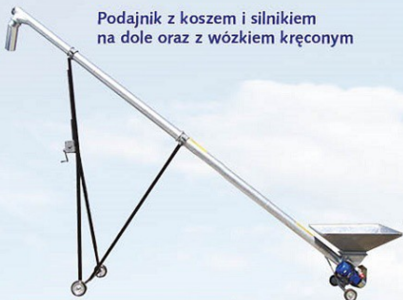
- średnice 125, 150, 200 mm - wydajność 10-12 t/h, 18-20 t/h, ok 40t/h przy długości 6m 125 mm występuje silnik 2,2 kw
